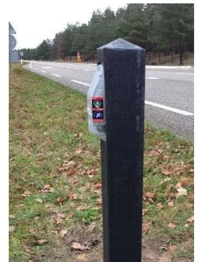
Figuur 11: Het virtueel hekwerk wordt geactiveerd door koplampen van voertuigen. © Traffic Safety Systems
